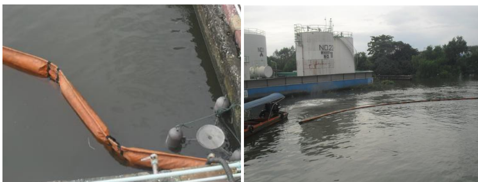
รูปที่ 2.6.1-1 Boom หรือ Oil Fence ที่เก็บประจำไว้ที่ห้องเก็บอุปกรณ์ทั้งสองด้านของท่าเทียบเรือ
