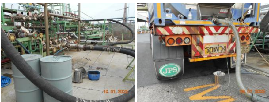
รูปที่ 2.6-1 ภาชนะรองรับสารเคมีในระหว่างการสูบลถ่ายเคมีภัณฑ์
